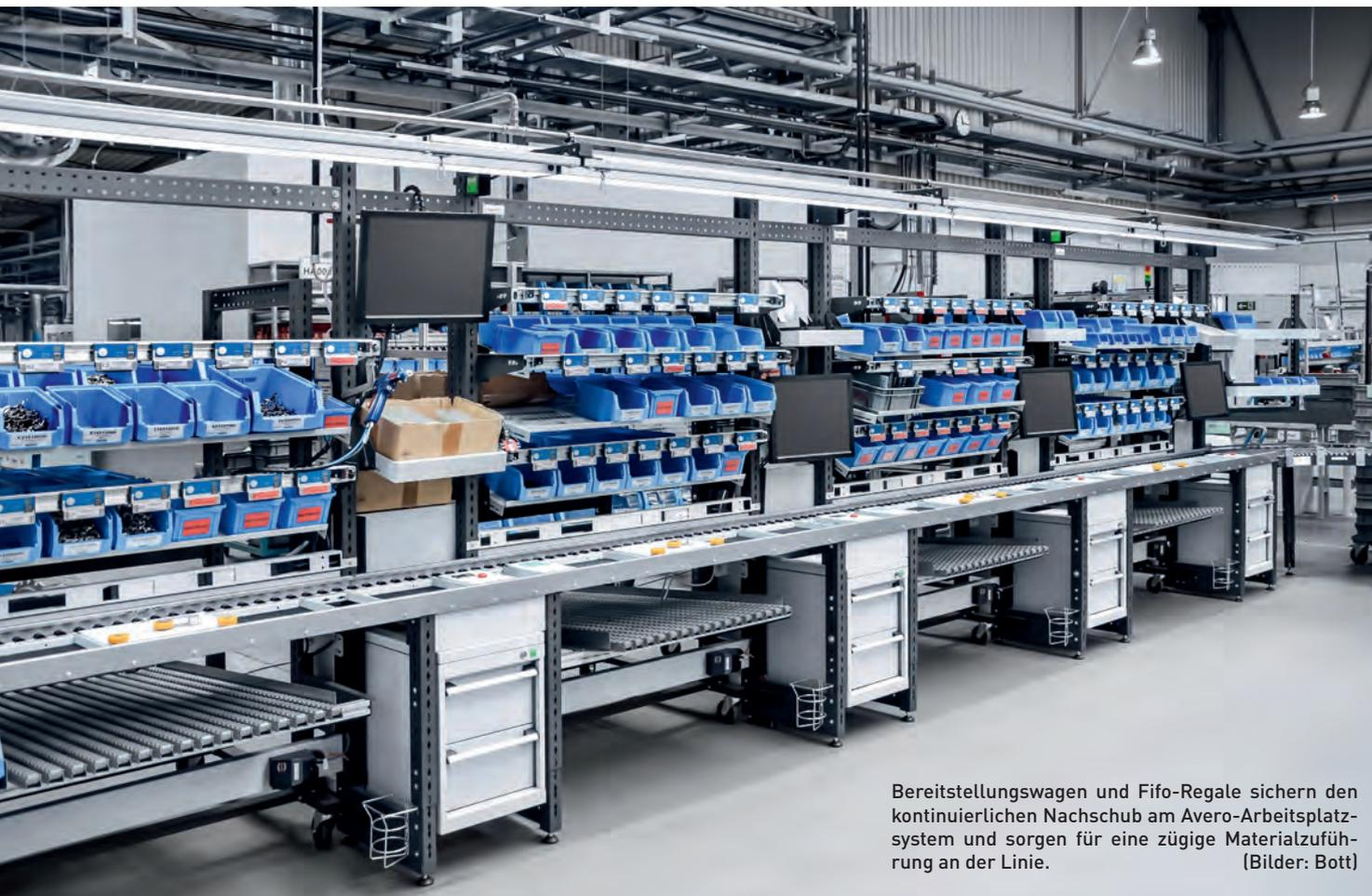
Bereitstellungswagen und Fifo-Regale sichern den kontinuierlichen Nachschub am Avero-Arbeitsplatzsystem und sorgen für eine zügige Materialzuführung an der Linie. (Bilder: Bott)
