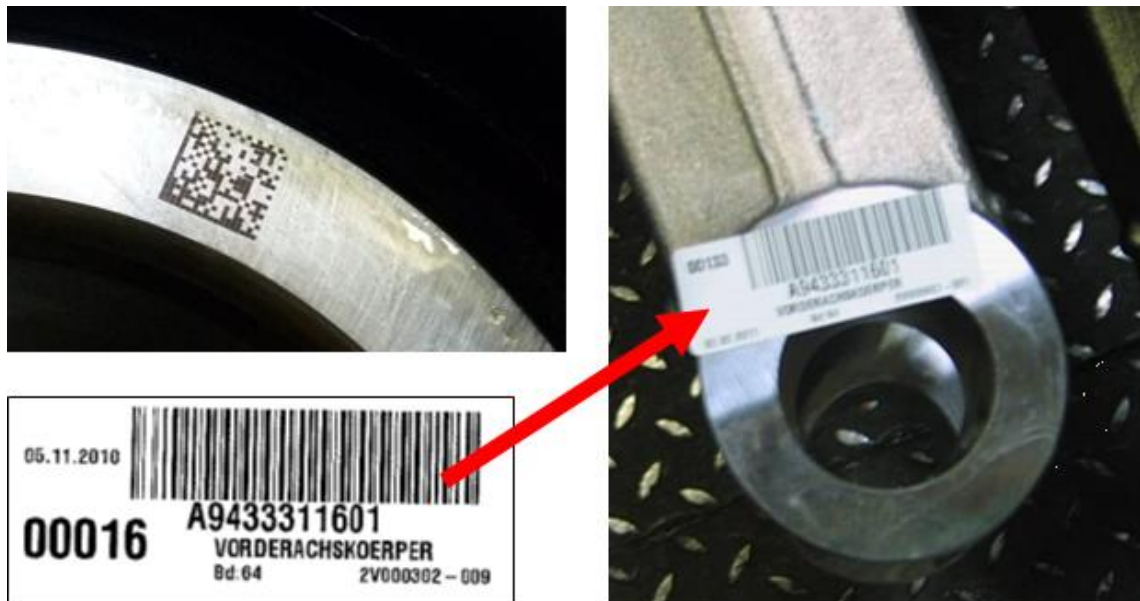
Maschinenlesbare Kennzeichnung: Bauteile werden gekennzeichnet, so dass sie vor dem Verbau identifiziert und dokumentiert werden können.
