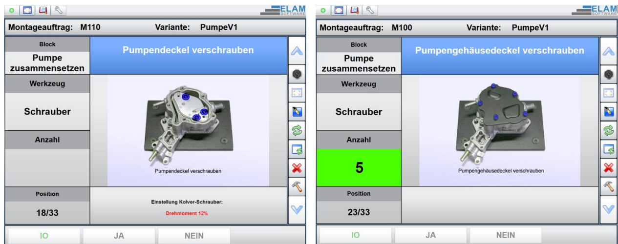
Einzelschrittanzeige: Informationen über den Arbeitsschritt werden übersichtlich visualisiert.
