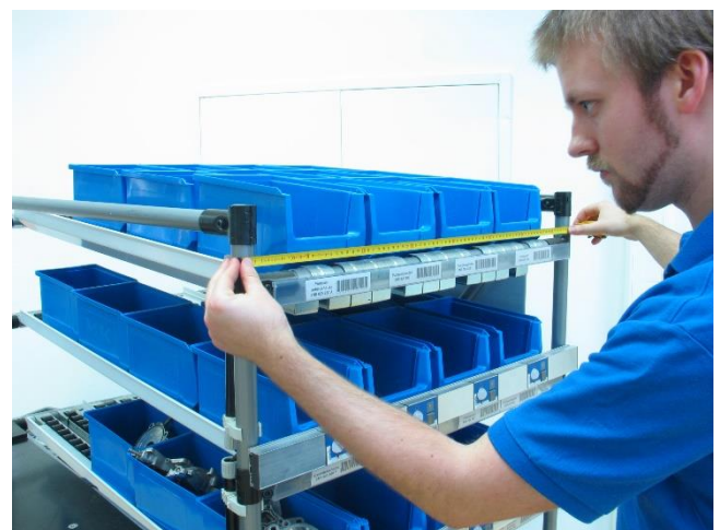
Abbildung 2: Ausmessen und Konfigurieren eines Pick to Light-Regals für die Ausrüstung des Arbeitsplatzes.
